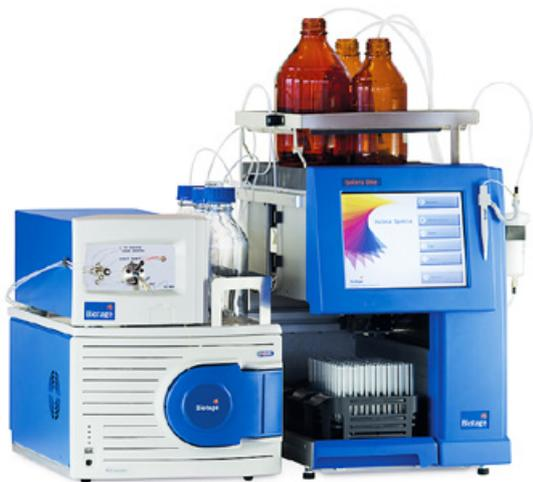
**Isolera Dalton, Biotage** позволяет разделять смеси органических веществ и проводить их идентификацию в режиме реального времени с помощью масс-спектрометрии. Установленный в этих системах интерфейсный модуль обеспечивает разделение потока подвижной фазы и подачу точного количества анализируемого материала к масс-спектрометрическому детектору, автоматически подстраивается к изменениям в скорости движения элюента и разным типам используемых флэш-картриджей.
