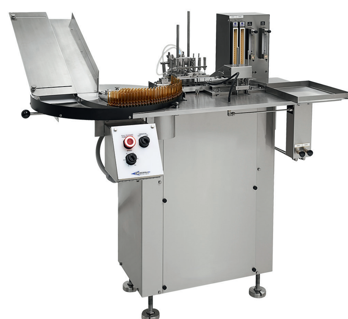
Моноблок для розлива и запайки ампул • от 0,1 до 30 мл \pm 0,5% • 15–120 контейнеров / мин
