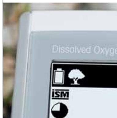
В дополнение к типовому и профессиональному режимам, прибор имеет специальный режим работы в полевых условиях. При этом время его автономной работы увеличивается за счет использования настроек по умолчанию.
