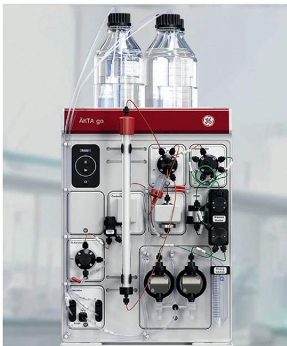
**AKTAgo, Cytiva** (бывшая **GE**) позволяет проводить тонкую очистку целевых белков, антител, полисахаридов, липидов и других биомолекул в ручном и автоматическом режимах. Эта компактная модульная система оборудована высокопроизводительным двух-плунжерным насосом, смесителем с возможностью создания градиента на стороне низкого давления, автоматической системой защиты колонок, тремя типами детекторов и системой клапанов.
