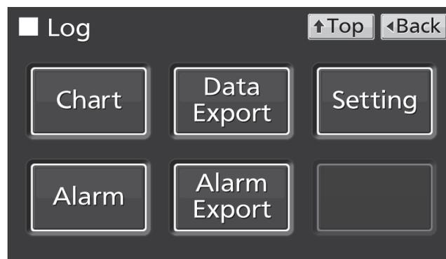
1. На экране Установки введите интервал регистрации (Log Interval). Нажмите клавишу «Применить» (Apply), чтобы сохранить введенное значение. Дисплей возвращается к экрану Журнала.
