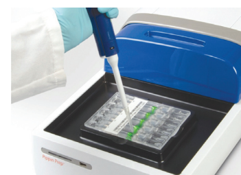
Препаративный автоматический электрофорез. Pippin Prep, SageScience
