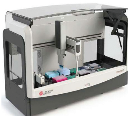
Станция автоматического выделения и раскапывания. Biomek, Beckman
