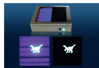
Обычный транслюминатор | Super-Bright транслюминатор
